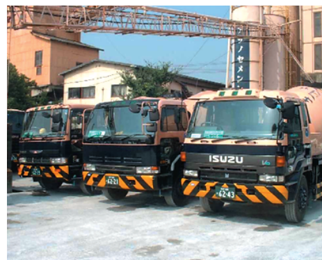
生コンミキサー車による、生コンクリート輸送
